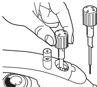
**MISE EN GARDE : Ne pas verser d'eau dans l'orifice de la valve.**
